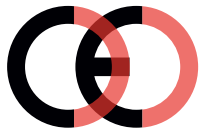
Virheellinen CE-merkki (liian lähellä)
