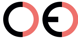
Virheellinen CE-merkki (liian kaukana)
